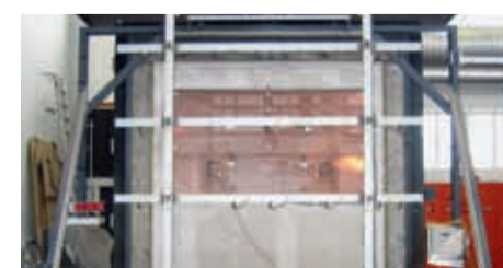
Disposizione della prova presso l'EMPA di Dübendorf: parete di gesso a secco con EI 90.
